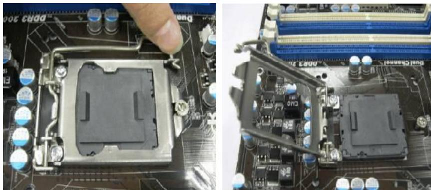
Шаг 2. Уберите защитную крышку: Приложите указательный палец к верхней части крышки. Большим пальцем возмитесь за противоположный край крышки и поднимите её как показано на фото.
